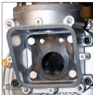
Solo 4 pernos para acceder a las válvulas antirretorno
